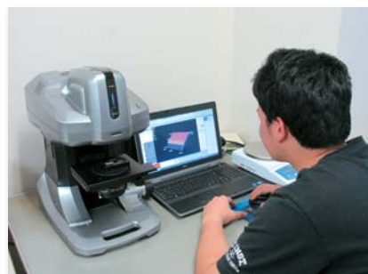
マイクروسコープによる供試体表面計測 Measurement of the specimen surface using a microscope
