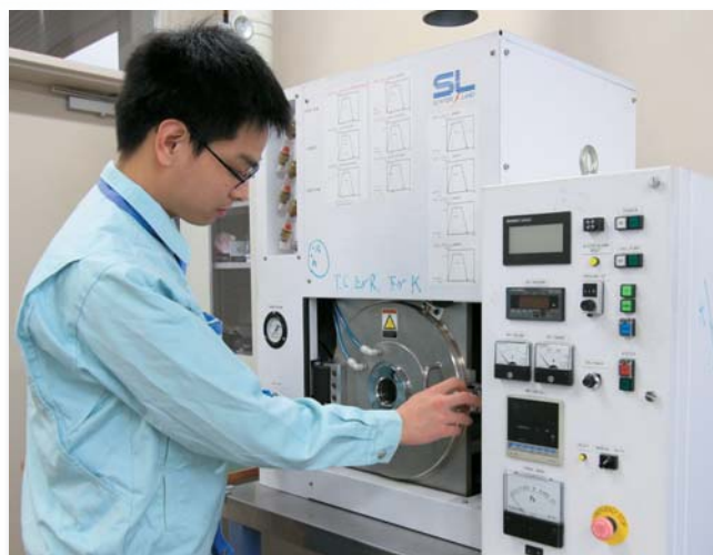
SPSによる \text{TiO}_2/\text{Ti6Al4V} 合金粉末焼結接合材の製造 Fabrication of sintered \text{TiO}_2/\text{Ti6Al4V} bonding materials by SPS technique
