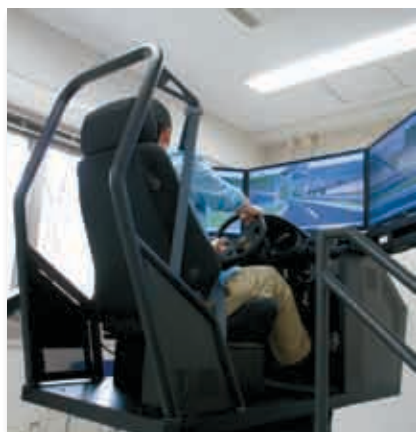
自動車用走行シミュレータを用いた運動特性の評価 Evaluation of Car Motion Characteristics with Driving Simulator
