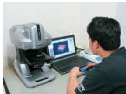
マイクロスコープによる供試体表面計測 Measurement of the specimen surface using a microscope
