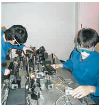
フォトポリマーを用いたホログラム記録実験 Experiment of holographic recording using photopolymer films
