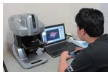
マイクロスコープによる供試体表面計測 Measurement of the specimen surface using a microscope
