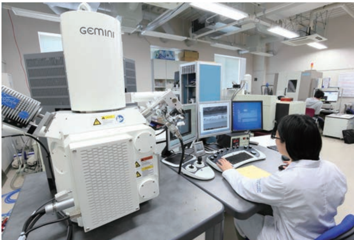
極低加速電圧 SEM による材料評価 Analysis by Ultra Low Vaco Type FE-SEM
