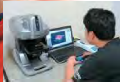
マイクロスコープによる供試体表面計測 Measurement of a specimen surface using a microscope
