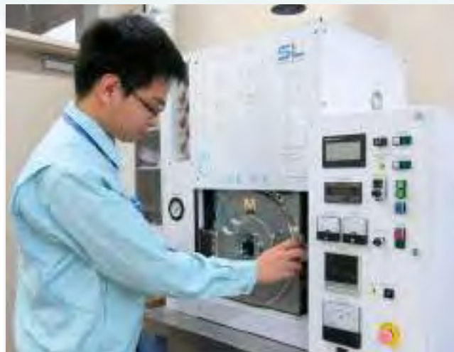
SPSによるTiO 2 /Ti6Al4V合金粉末焼結接合材の製造 Fabrication of sintered TiO 2 /Ti6Al4V bonding materials using SPS technique
