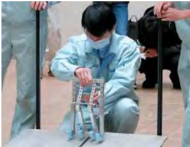
受動歩行ロボットの設計・製作 (総合製作・3学年) Design and manufacture of the passive walking robot (Creative design and manufacture, 3rd grade)
