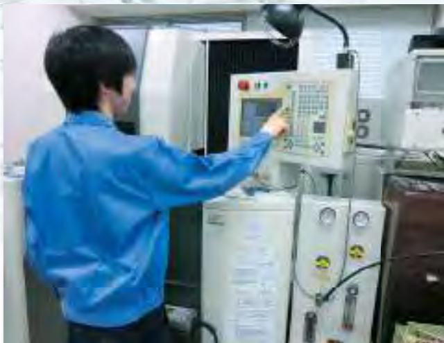
チタン系セラミックスのワイヤ放電加工 Wire electrical discharge machining of titanium-based ceramics
