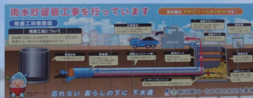
雨水貯留管工事の流れ
